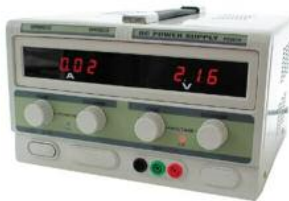
Ci-dessus : tension de 0 à 30 volts et jusqu'à 10 ampères, avec affichage numérique (environ 220 euros) Un modèle plus important est disponible avec une sortie jusqu'à 20 ampères. Un boîtier de commande n'est pas nécessaire avec ce type de matériel.
