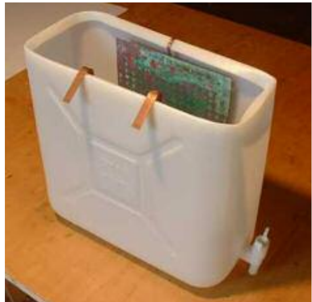
Réservoir vertical avec robinet, 35x35x15 cm contenant 18 litres, avec grille de cuivre à l'anode pour placage, faite à partir d'un bidon en plastique robuste dont le sommet a été découpé et le bord replié. Le grand volume de l'électrolyte n'est pas épuisé par de la gravure électrolytique ou du placage et ne pose pas de problème d'élimination.
