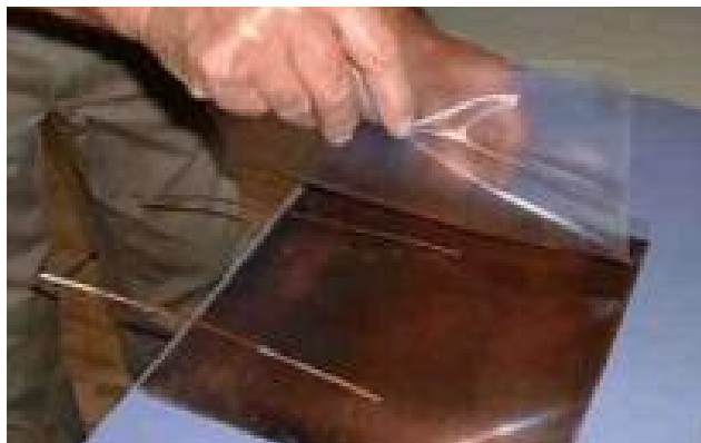
Ci-contre : une feuille en plastique transparent auto adhésive est appliquée sur le dos de la plaque pour fixer les lamelles de contacts
