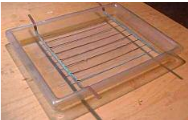
Grille de cathode de cuivre dans le bac de gravure en plastique de 48 X 36 cm et 6 cm de profondeur, soit une contenance de plus de 10l d'électrolyte.
